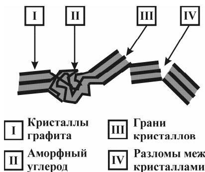
Рис.6. Схематичное изображение различных по энергии участков поверхности сажи.
